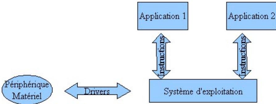
FIGURE 10.1 – Schéma de fonctionnement d'un système d'exploitation
